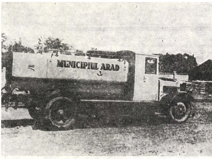
Autocisternă de 3 350 litri capacitate, fabricată în 1928 (sus), și autostropitoare produsă în 1926 pentru primăria municipiului Arad (jos)
